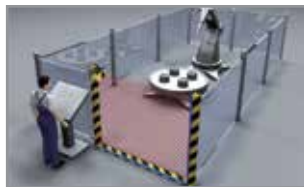
Zugangssicherung zu automatisierter Produktion
