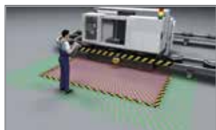
Gefahrenbereichsabsicherung an fahrerlosen Transportsystemen
