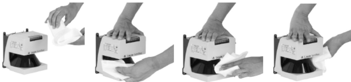
図 11.8-1 : フロントウィンドウのクリーニング
