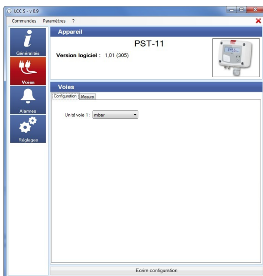
Configuration Voies capteur classes 110, 210 et monostats
