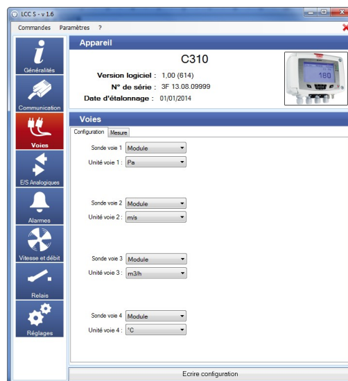
Configuration Voies capteur classe 310
