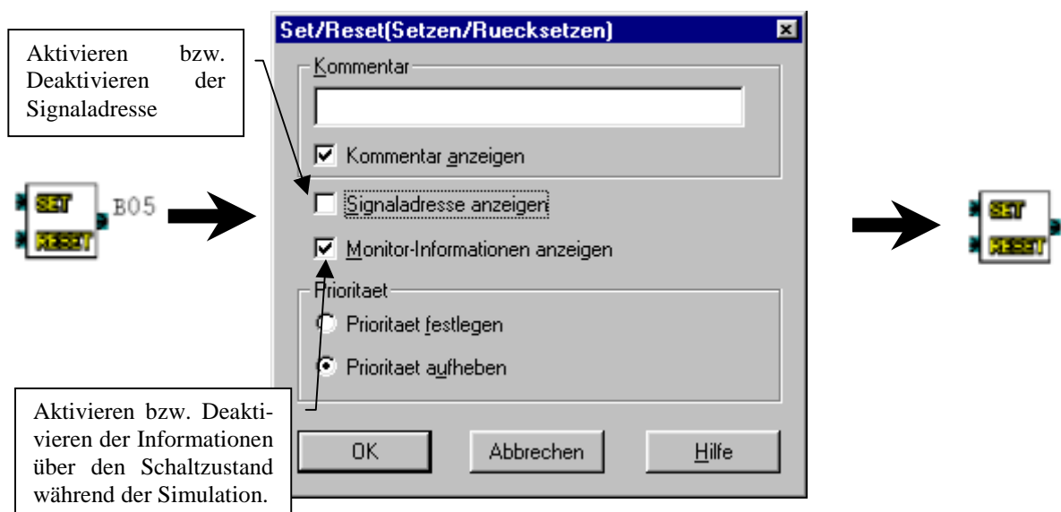
Abb. 1.23 – Optionen eines SET/RESET-Funktionsblocks.
