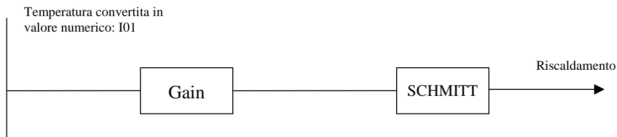
Fig. 1.55 Schema logico di regolazione della temperatura.
