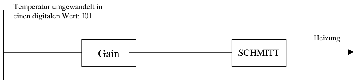
Abb. 1.55 – Schaltschema für eine Temperaturregelung.
