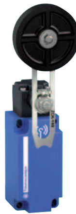
Rollenhebel, mit Elastomerrolle, langenverstellbar, \varnothing 50 mm (1)
