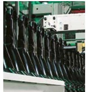
Der ideale Füllstandssensor SMART LEVEL durchdringt nicht nur dickere Glas- und Kunststoffwände, sondern kompensiert Feuchtigkeit, Schaum und Anhaftung.
