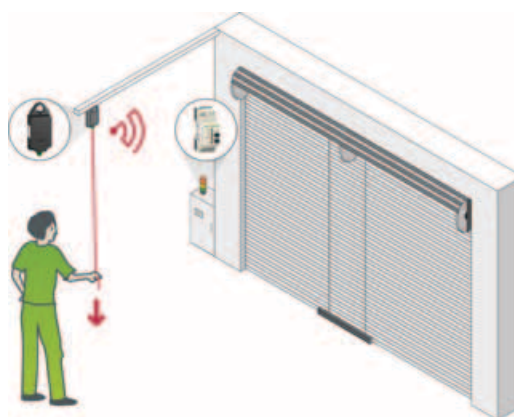
Abb. C: Seilzugschalter für automatische Tore
