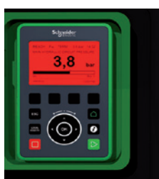
Défaut en cours : le rétroéclairage rouge de l'écran s'active automatiquement
