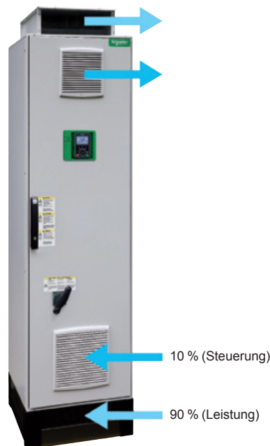
Kühlsystem mit 2 separaten Luftströmen
