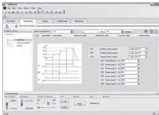
Einstellen der Vorwahlfrequenzen mit der Inbetriebnahmesoftware SoMove
