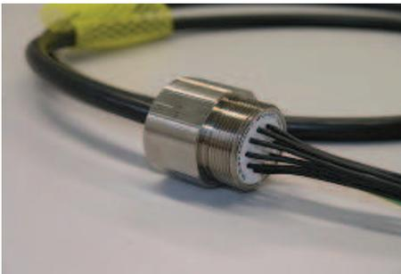
Ausführung als Leitungseinführung mit Radox Schlauchleitung 10adrig, Verschraubungsausführung kundenspezifisch, Zugentlastung integriert
