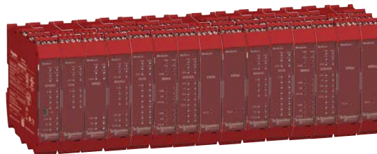
Größte Ausbaustufe: eine Sicherheitscontroller-CPU verbunden mit vierzehn Erweiterungsmodulen (1) über den Rückwand-Busstecker: 128 Eingänge und 16 OSSD-Paare oder 32 einkanaligen OSSD + Statusausgänge
