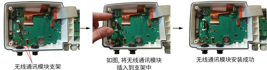
模块成功连接后,合上变送器外壳并根据详细的变送器操作手册设置无线通讯功能。
