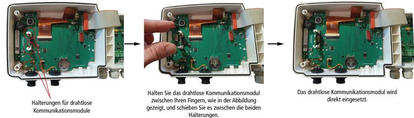
Sobald das Modul angeschlossen ist, schließen Sie den Transmitter und lesen Sie das vollständige Benutzerhandbuch, um die drahtlose Kommunikation einzustellen.
