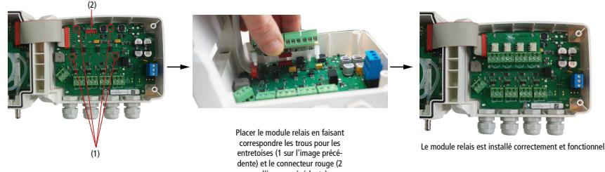
Le module relais est installé correctement et fonctionnel.
