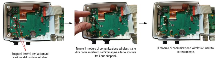
Una volta collegato il modulo, chiudere il trasmettitore e fare riferimento al manuale utente completo per impostare la comunicazione wireless.
