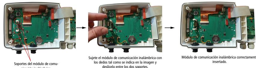
Una vez conectado el módulo, cierre el transmisor y consulte el manual de instrucciones completo para ajustar el rango de comunicación inalámbrica.
