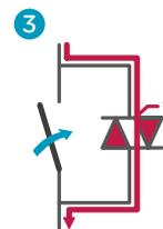
Fermeture du contact sous potentiel nul. Absence d'arc : contact préservé.
