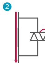
Le semi-conducteur est commandé avant l'ouverture du contact.
