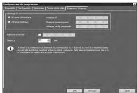
Fenêtre de configuration de l'extension Ethernet
