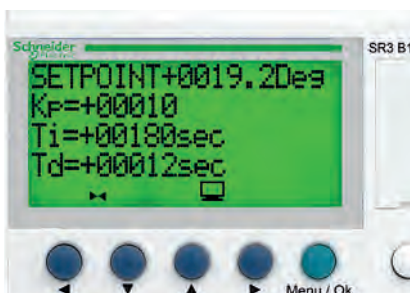
Modification des paramètres (Kp, Ti, Td) avec les touches de programmation et paramétrage
