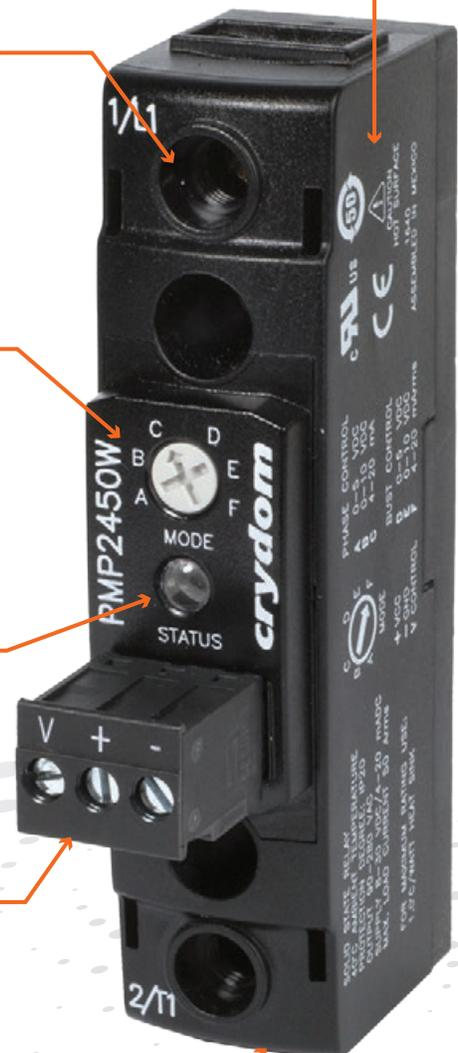
La **série PMP** de relais statiques gradateurs est idéale pour des applications nécessitant une variation de puissance de 0 à 100% en réponse à un signal de commande analogique provenant d'un appareil de commande tel qu'un automate ou un régulateur de température.
