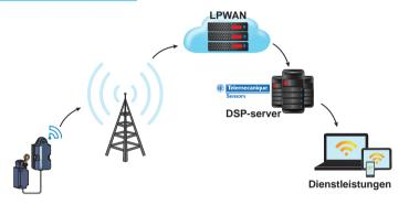
Das Standalone-Sendegerät XIOT11SEppp ermöglicht die Auswertung der Zustandsänderungen von einem oder zwei Trockenkontakten über eine LPWAN-Verbindung (Funkverbindung). Die übertragenen Informationen werden im Internet über einen Webbrowser oder auf Mobilgeräten über eine IOS- und Android-App zur Verfügung gestellt.
